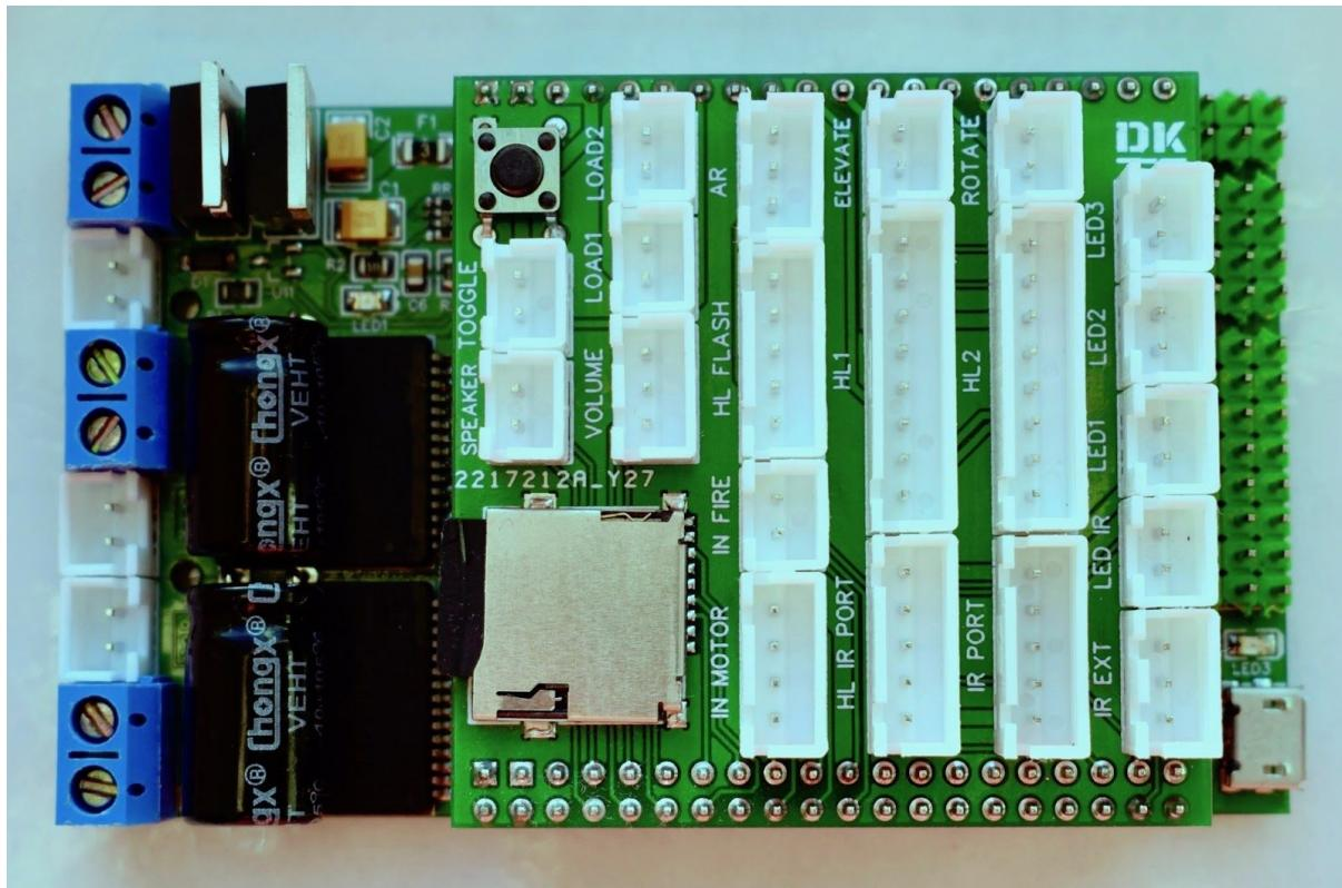
Продвинутая плата для управления танком с поддержкой 8-канальных пультов управления, возможностью записи своих звуков и большим количеством настроек.
